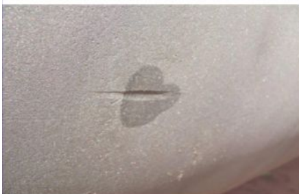
Локальный дефект типа "задир", обнаруженный бесконтактным методом на подземном трубопроводе
